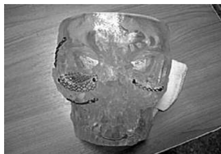
Рис. 1. Стереолитографические модели пациентов и этапы припасовки титановых сетчатых имплантатов.
